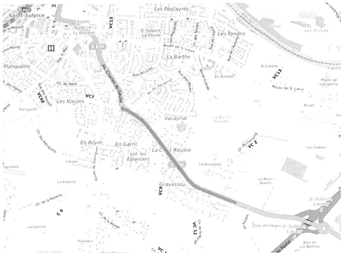
Il s'agissait de renforcer et remplacer le réseau existant de la Route de Lavour par une conduite en  $\varnothing 150$  mm fonte sous chaussée. A la vue de la multitude des réseaux existants, le réseau d'eau potable projeté sera positionné au mieux dans l'axe de la demi-chaussée.
